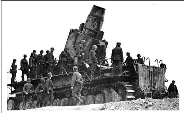
Este mortero alemán de 600 mm se construyó para demoler fortificaciones. Estaba montado sobre un vehículo pesado autopropulsado que se movía mediante una oruga y, aunque su tamaño no era excesivo, pesaba 124 toneladas, así que su velocidad era de unos escasos 10 Km./h. Este mortero podía disparar tanto proyectiles sólidos como explosivos, la media de peso de cada proyectil era de unas 2 toneladas y el alcance de 4,3 Km
