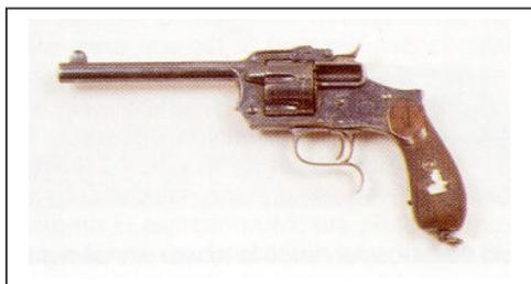
En la década 1870-1880 hubo dos ensayos de un arma que no llegaron a producirse industrialmente. El teniente Ibarra, de Artillería, y el ingeniero Piñol, de la Fábrica de Oviedo, modificaron un revólver *Lefauchaux* de 1863 para conseguir que expulsara las vainas por medio de los gases producidos durante el disparo. Aunque las pruebas fueron bien, la aparición de los cartuchos de
